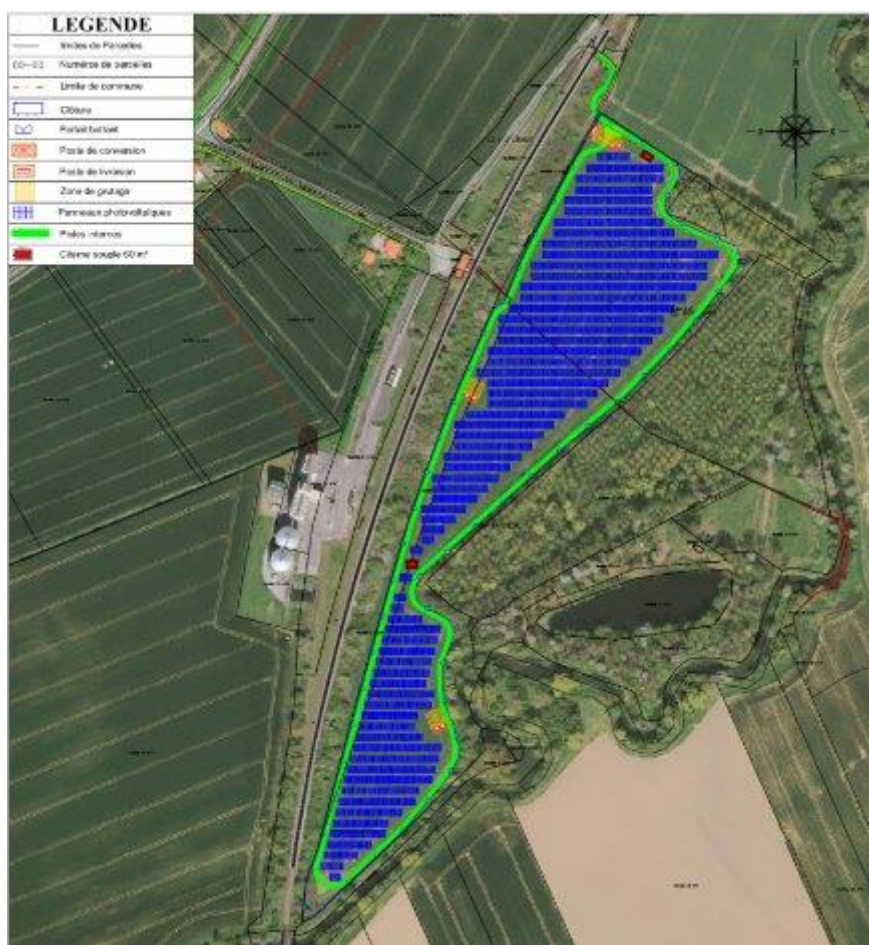
Figure 2 - Calepinage de la centrale solaire
