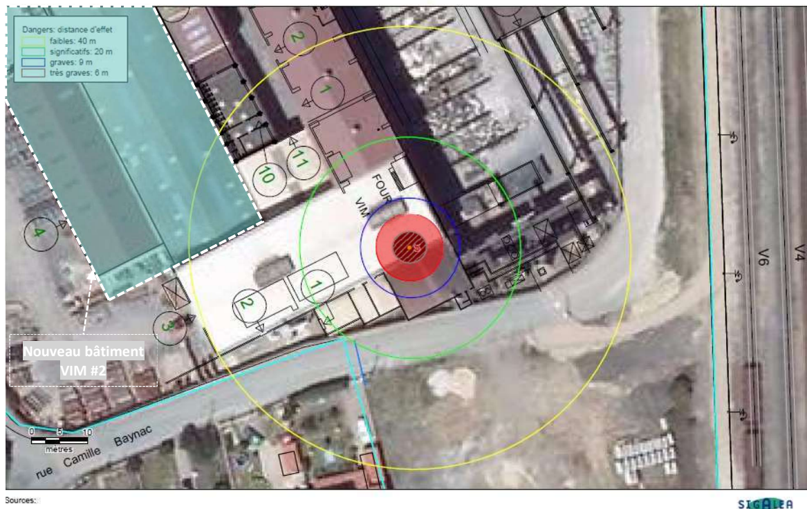
Figure 51 : Zones d'effets de surpression du PhD ACI10 « Explosion de vapeur au niveau du four VIM »
