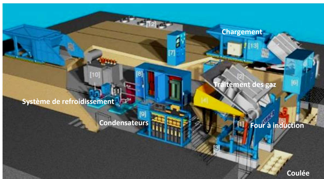
Figure 13 : Représentation simplifiée de l'installation d'un four à induction
