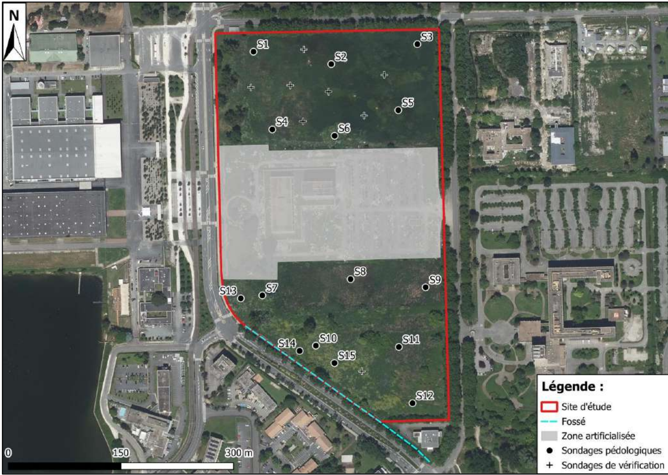
Figure 63 : Plan de localisation des sondages pédologiques (Source : Etude de délimitation de zones humides – CERAG 2025)
