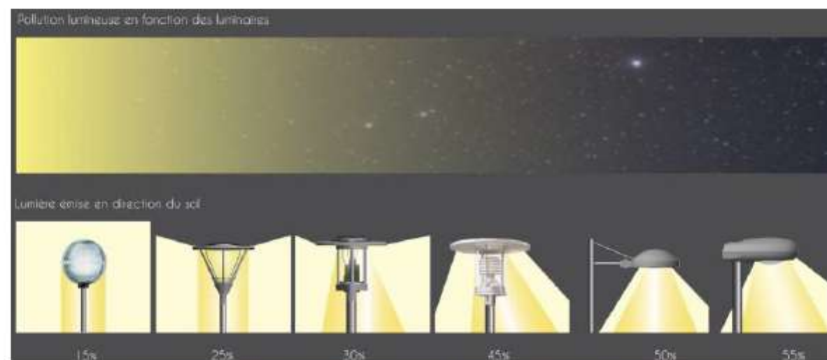
Figure 6 Efficacité de flux et pollution lumineuse en fonction du type de luminaire (Source : Acere)
