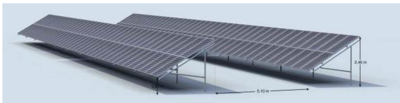
Figure 12 : Schéma de principe de l'agencement des tables d'assemblage (Source : TrinaSolar)
