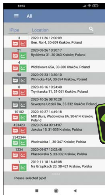
RATMONmobile - Application Android permettant de visualiser l'état des appareils et des boucles d'alarme.
