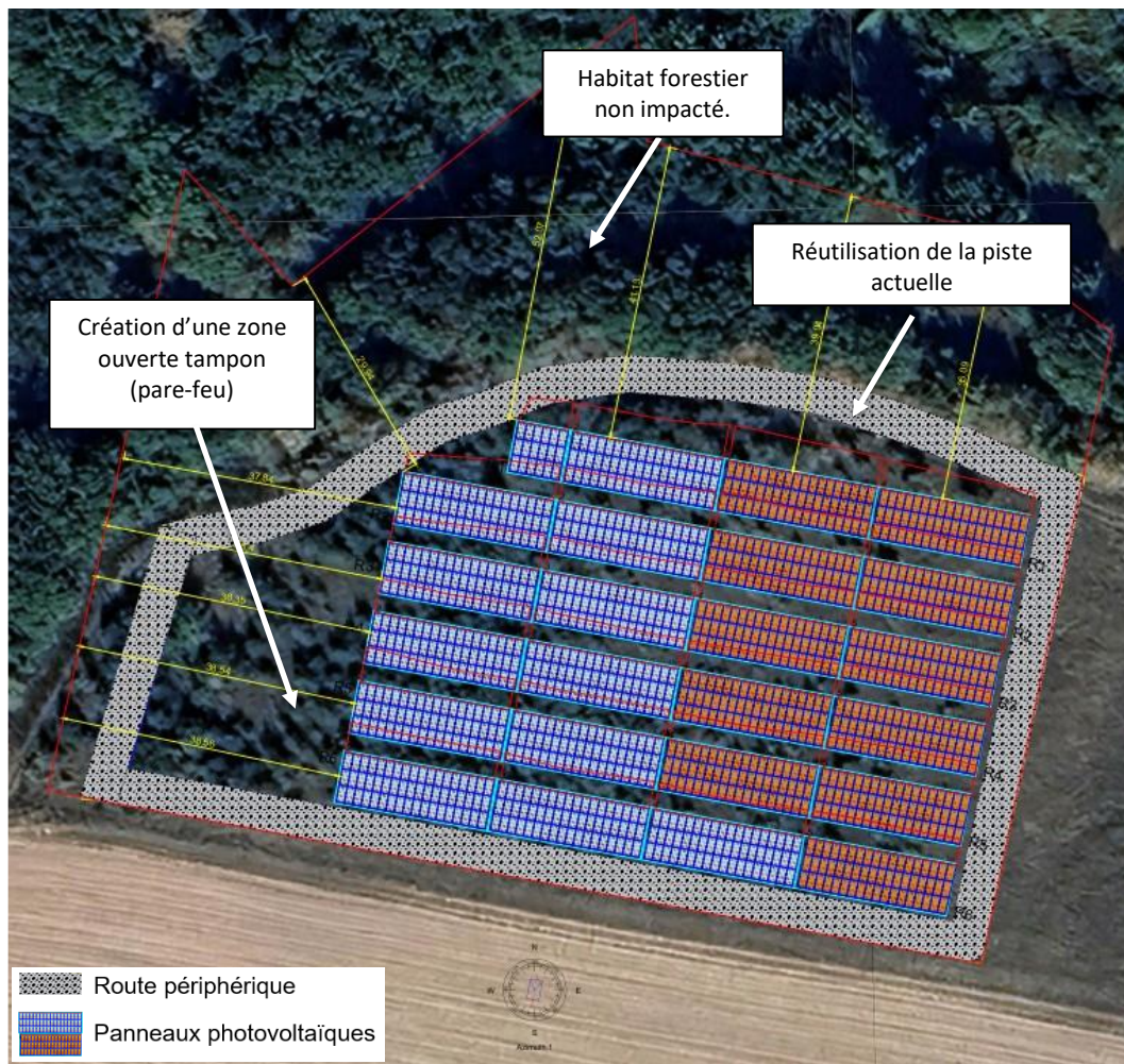
Figure 8 : Calepinage envisagé de la centrale
