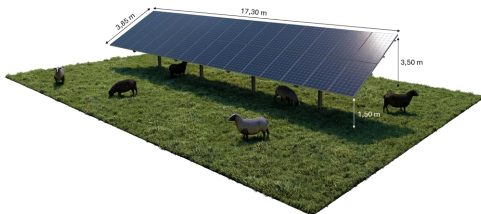
Figure 4 : représentation d'une table photovoltaïque © Corsica Sole
