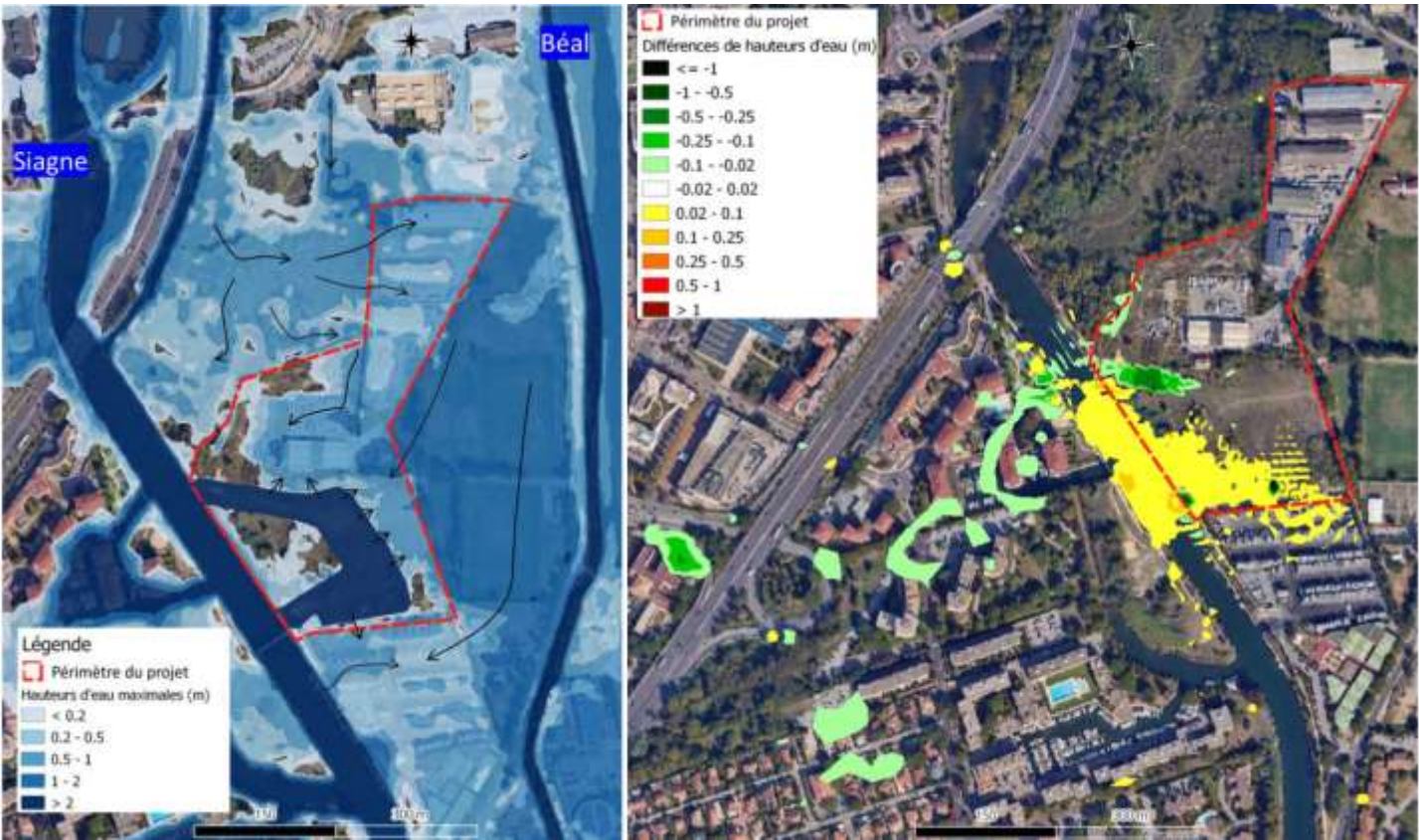
Cartographie des hauteurs d'eau et axes d'écoulement pour le scénario 3 (à gauche) et cartographie des impacts hydrauliques du scénario 3 par rapport à l'état actuel (à droite) – Q1000
