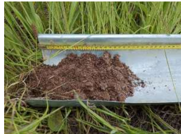
Sondage n° 6. Refus de tarière dès 20 cm. Sol limono-sableux avec quelques éléments plus grossiers.
