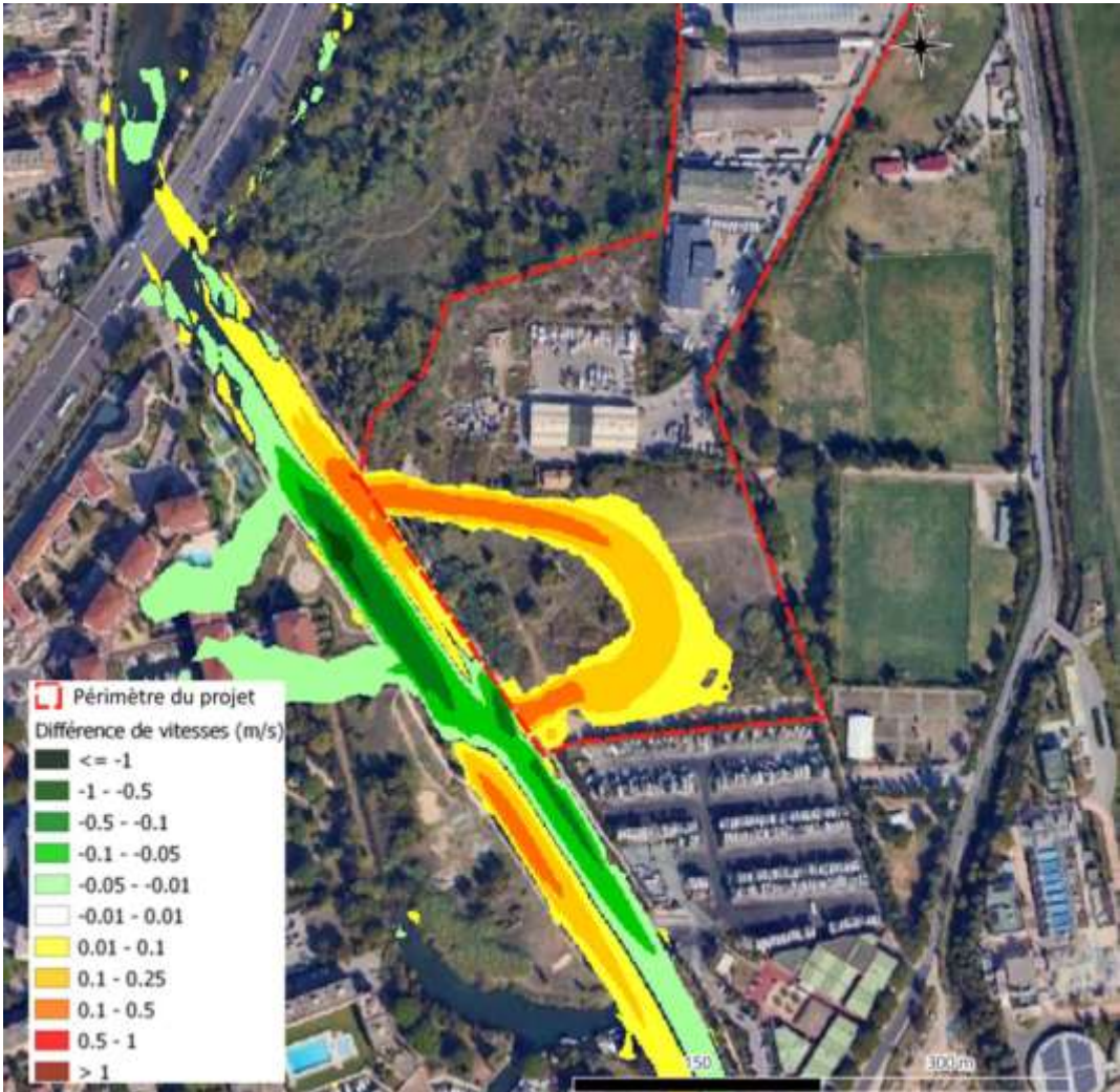
Cartographie des différences de vitesses d'écoulement entre le scénario 3 et l'état actuel - Q10
