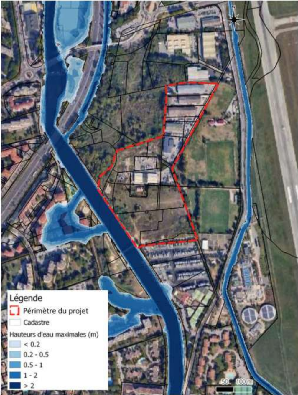
Cartographie des hauteurs d'eau maximales pour une crue trentennale de la Siagne -Etat actuel
