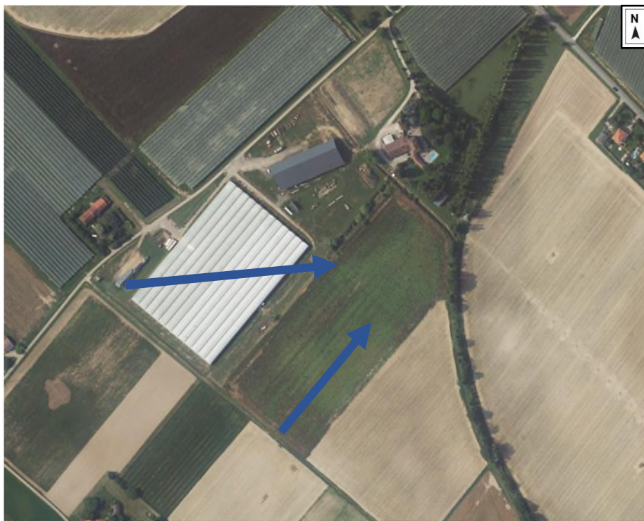
Figure 04 – Pente du terrain naturel
