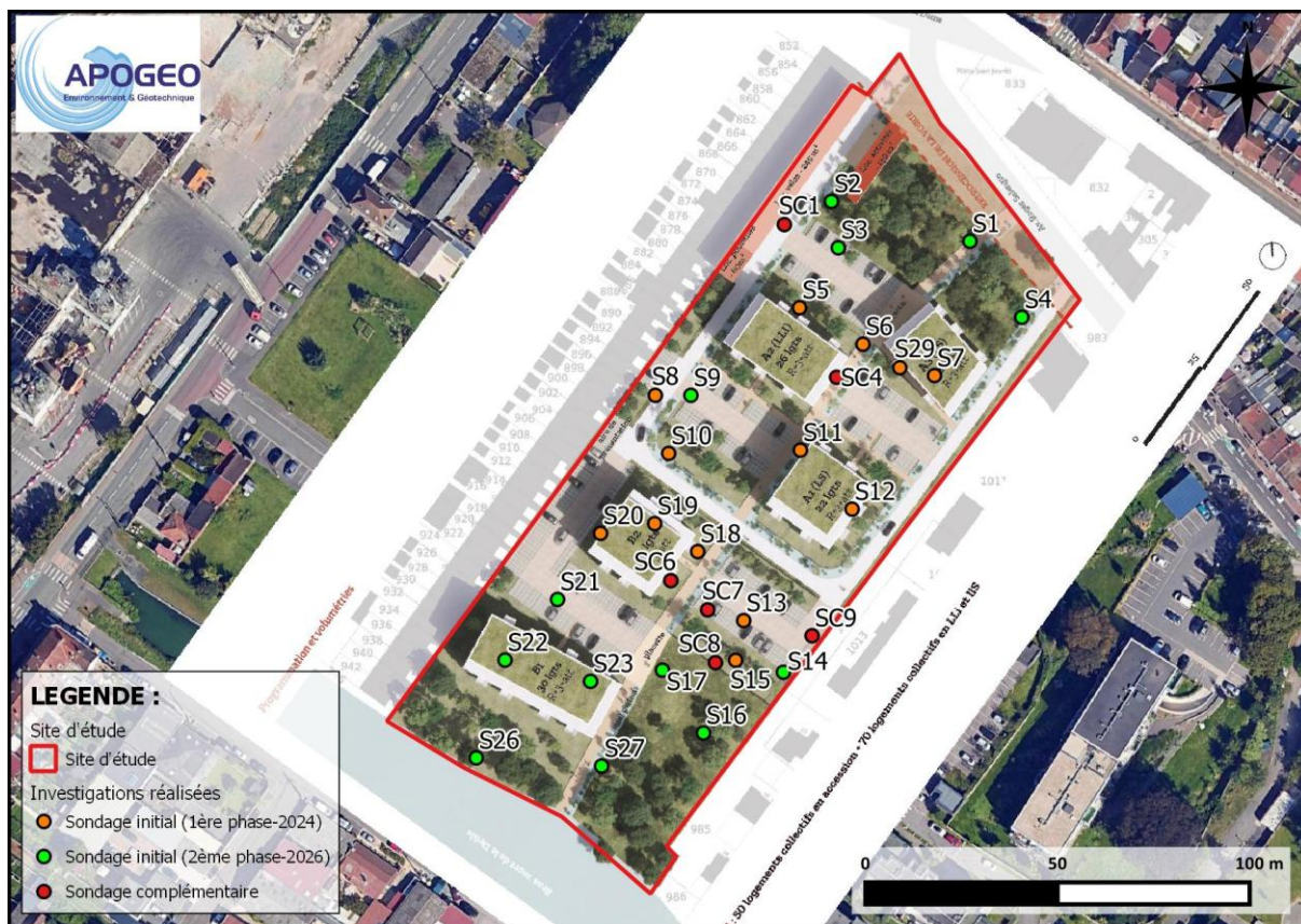
Figure 5 : Localisation des investigations réalisées sur plan masse
