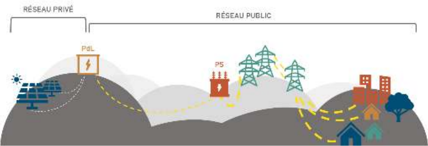
Figure 2 : Raccordement électrique d'un parc photovoltaïque (PdL – Poste de livraison | PS – Poste source) L'énergie que produisent les panneaux est transmise au(x) poste(s) de livraison par le biais de câbles électriques enterrés.
