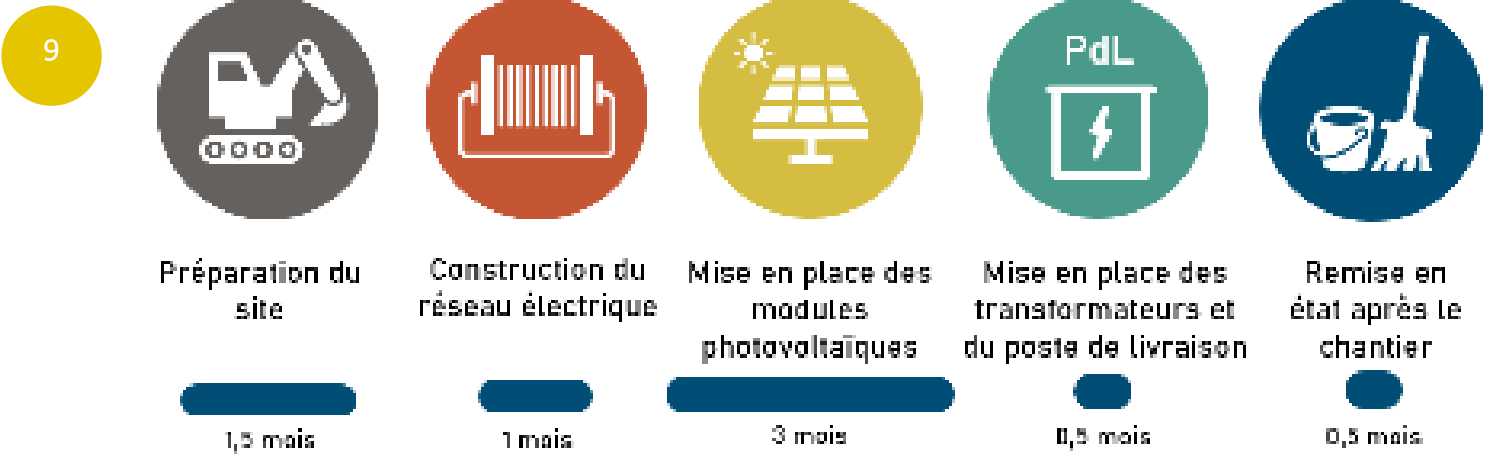
Figure 1 : Durées approximatives et phases de travaux de construction d'un parc photovoltaïque Remarque : Les délais sont donnés à titre indicatif. Certaines phases peuvent se dérouler en parallèle.
