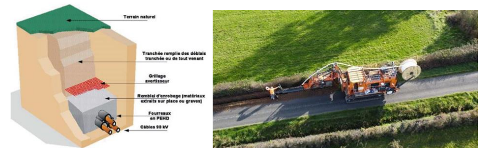
Figure 11 : pose des lignes souterraines (source : CEGELEC)
