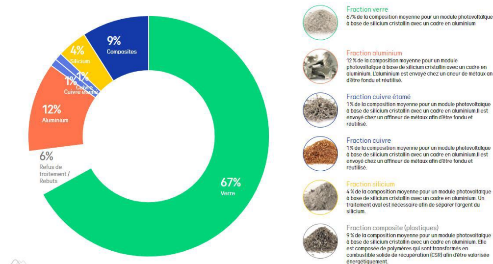
Figure 31 : Différentes fractions composant un panneau photovoltaïque (source : SOREN)
