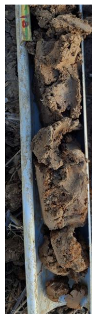
Figure 11 : Traces d'oxydes de fer observés en profondeur
