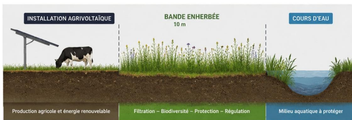
Figure 3 : Schéma d'une installation agrivoltaïque avec bande enherbée de protection en bord de cours d'eau
