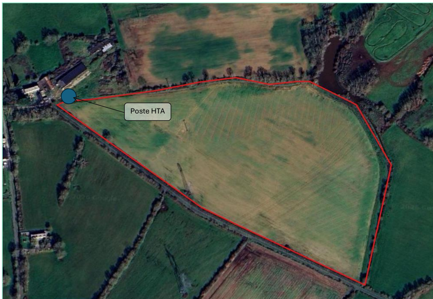
Raccordement envisagé en piquage de ligne sur un poste de distribution publique à proximité du site
