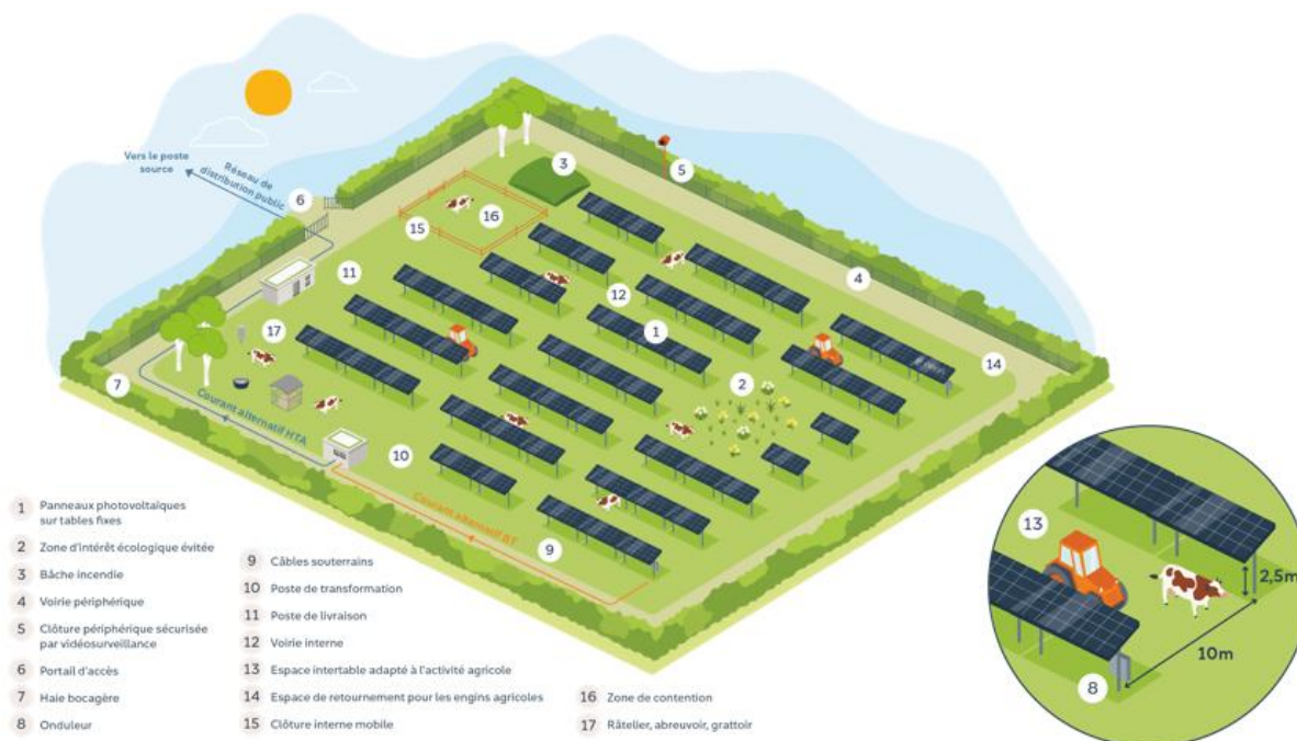
Schématisme d'un parc d'ombrières agrivoltaïques en co-usage avec élevage bovin
