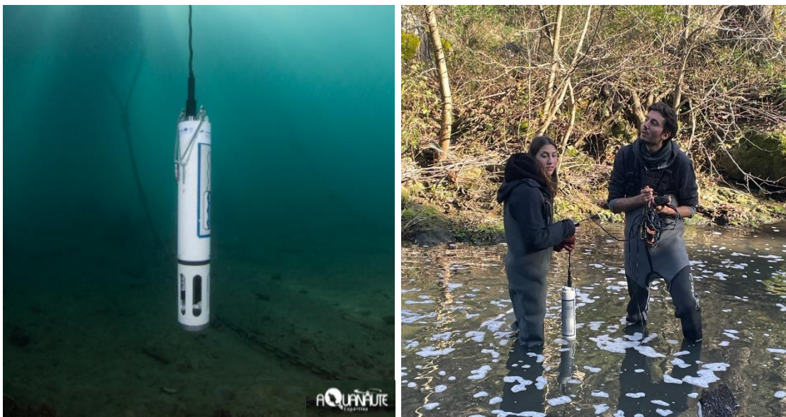
Figure 3: sonde multiparamétrique et mesures physico-chimiques
