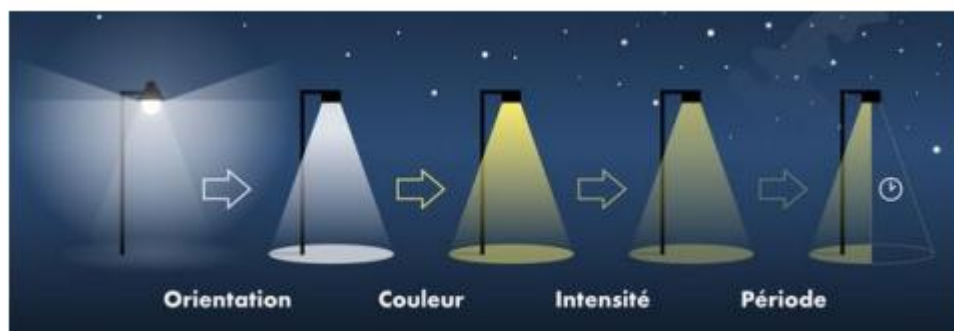
Figure 11 : Principes de modification des candélabres pour respect de la trame noire (source : PLUiH de Toulouse Métropole, 2026)
