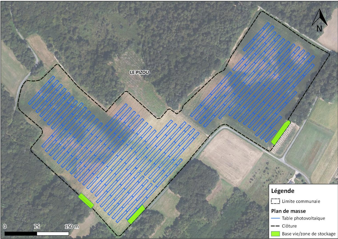
Figure 16 : Localisation de la base de vie et des zones de stockage dans le cadre du projet agrivoltaïque sur la commune du Pizou (Source : RENNER ENERGIES, NCA Environnement)
