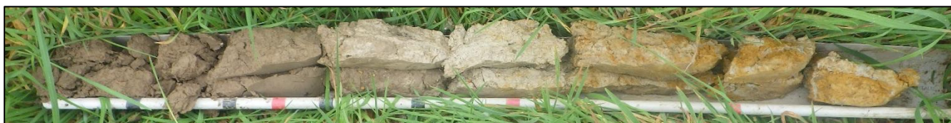
Sondage n°3 : traces rédoxiques à partir de 10 cm, s'intensifiant en profondeur ( Vb - zone humide )
