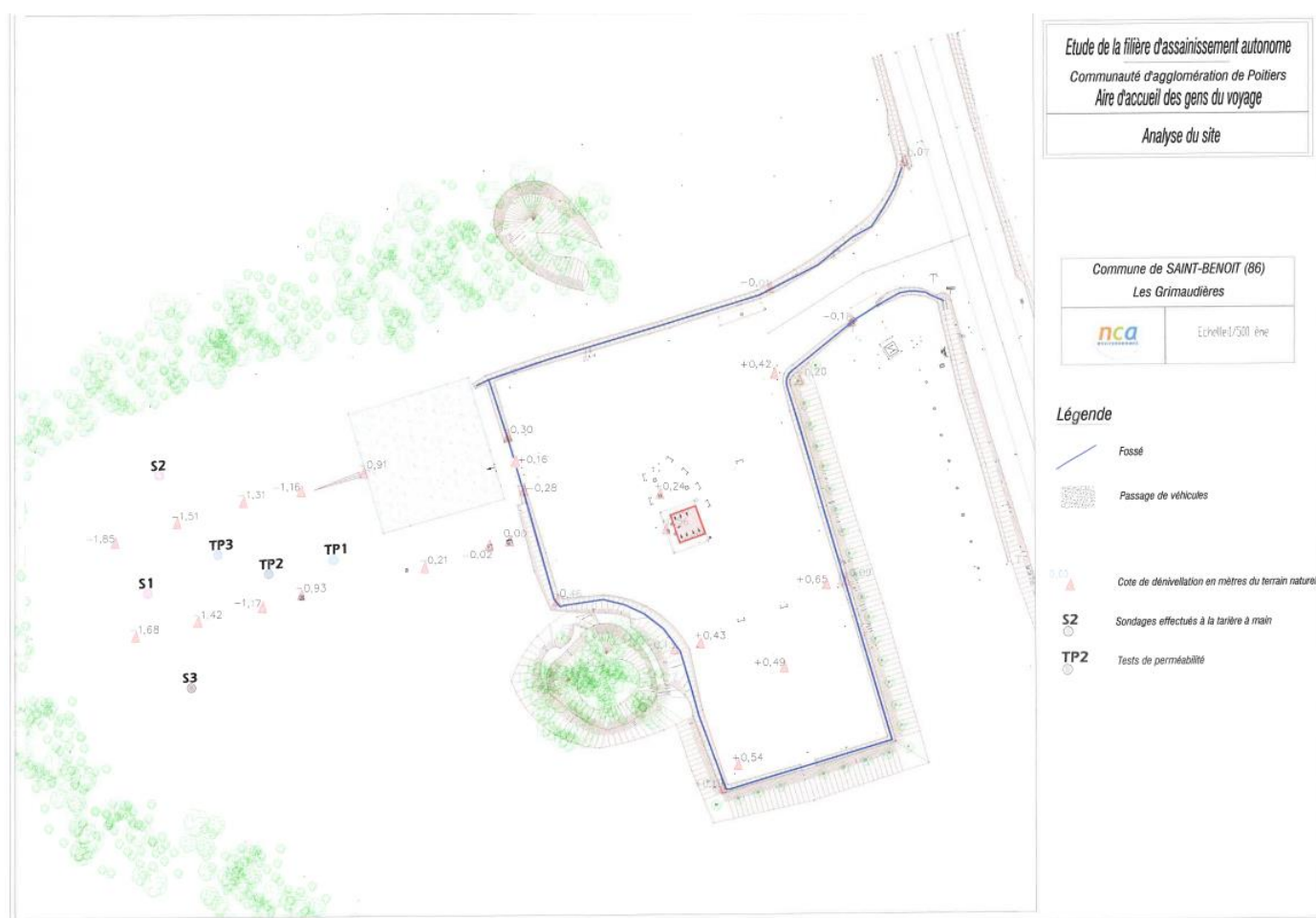
Figure 6 : Localisation des essais de perméabilité du sol (Source NCA)
