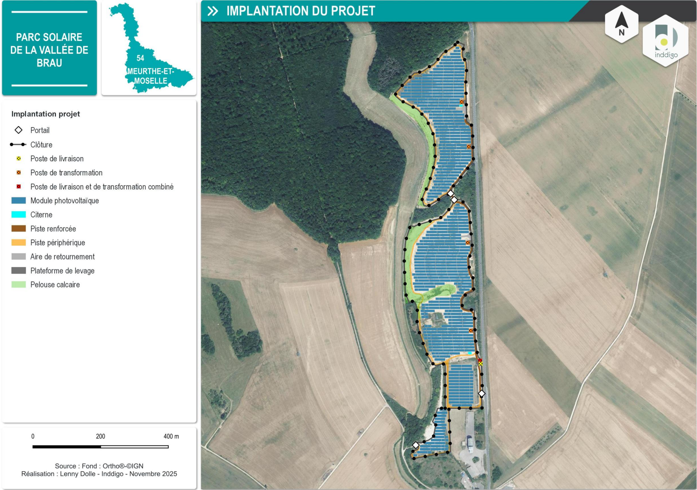
Carte 9 : Plan d'implantation du projet photovoltaïque de La Vallée de Brau sur fond IGN 1/25 000 ème (source : EDF power solutions France)
