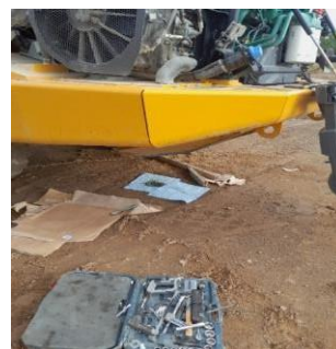
Exemple de kit antipollution présent directement sur la zone de chantier et visible (à gauche) et utilisation d'une feuille absorbante pour absorber une fuite d'huile de moteur (à gauche) (Biotope, 2024)
