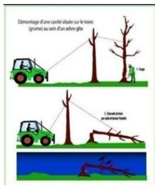
Schéma présentant les précautions à prendre en cas d'abattage par démontage mécanique (© Ecosphère)
