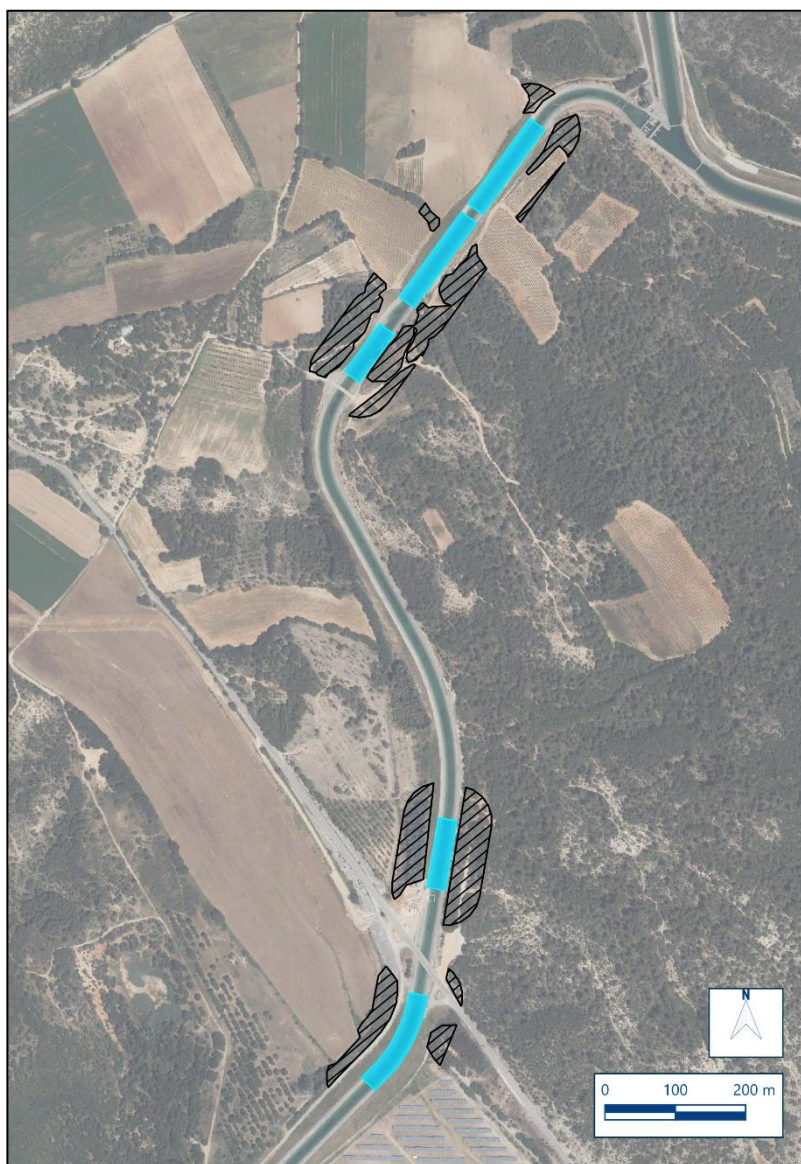
Figure 6 : Variante retenue pour l'implantation des ombrières photovoltaïques
