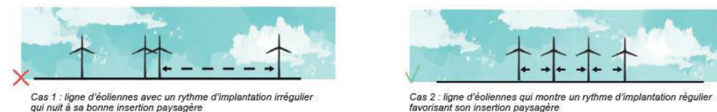
Figure 7 : Schémas illustrant l'incidence du rythme d'implantation des machines sur la lisibilité d'un parc éolien (source : Ouest am')
