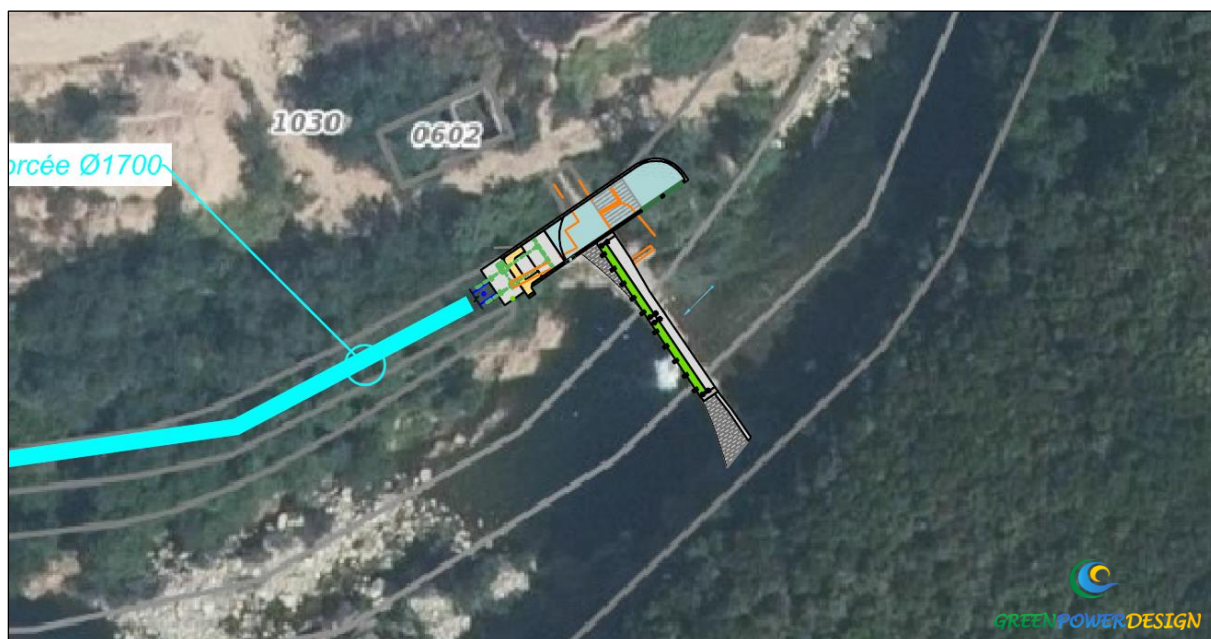
Figure 36 : Projection du barrage clapet et de la prise d'eau -Scénarios 3A et 3B
