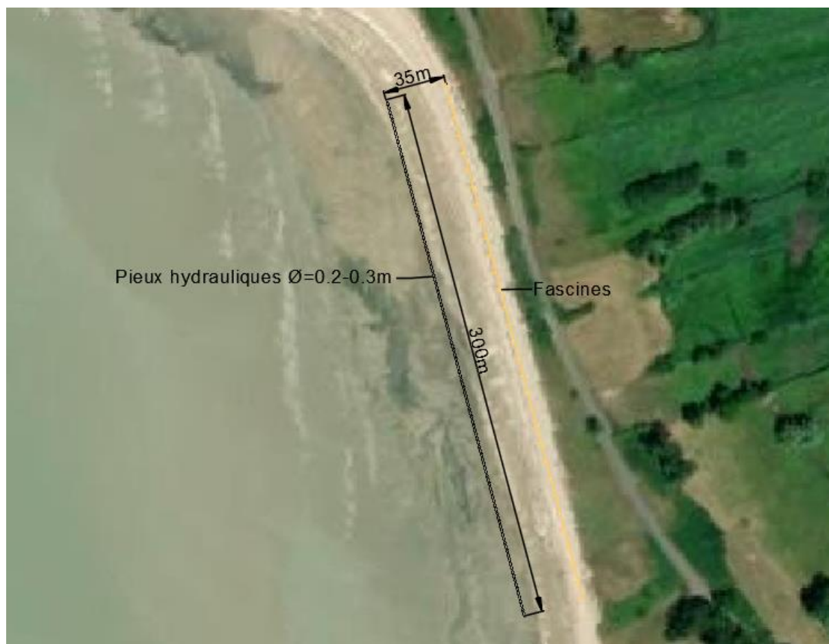
Figure 17 : Emprise totale des pieux hydrauliques et des fascines
