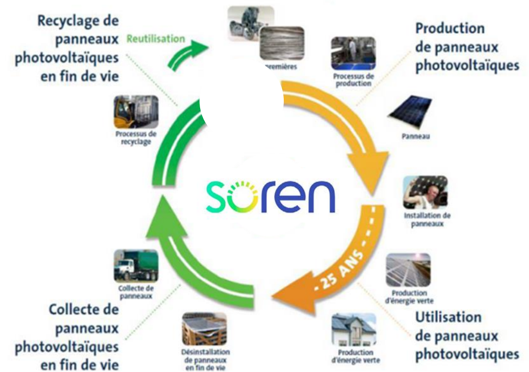
Figure 4 : Cycle de vie des panneaux photovoltaïques en silicium cristallin
