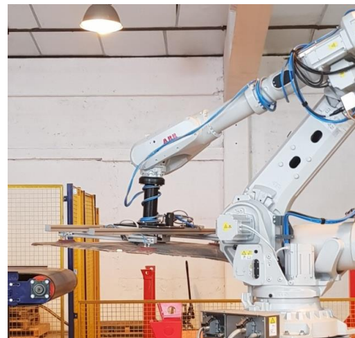
Figure 6 : Chargement du modules laminés avant découpage, broyage et séparation des éléments
