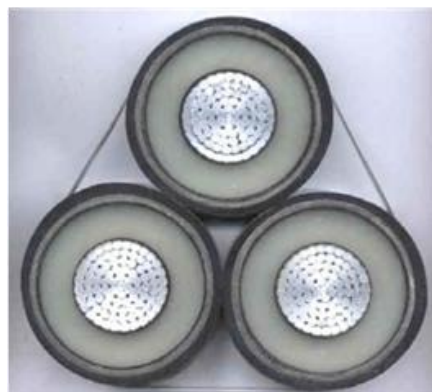
Coupe de câbles conducteurs souterrains
