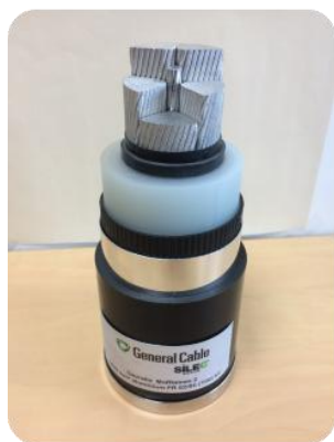
Détail de la structure d'un câble souterrain
