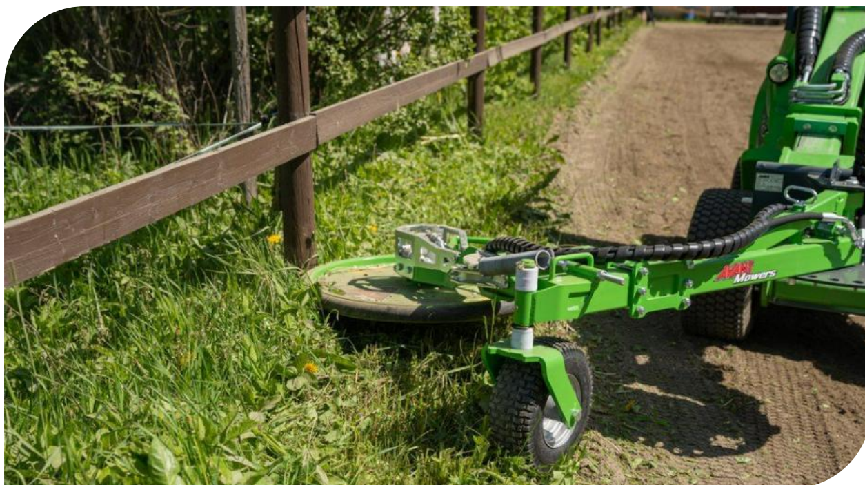
Exemple d'équipement pour un broyage latéral, également compatible avec des ombrières photovoltaïques installées sur monopieu
