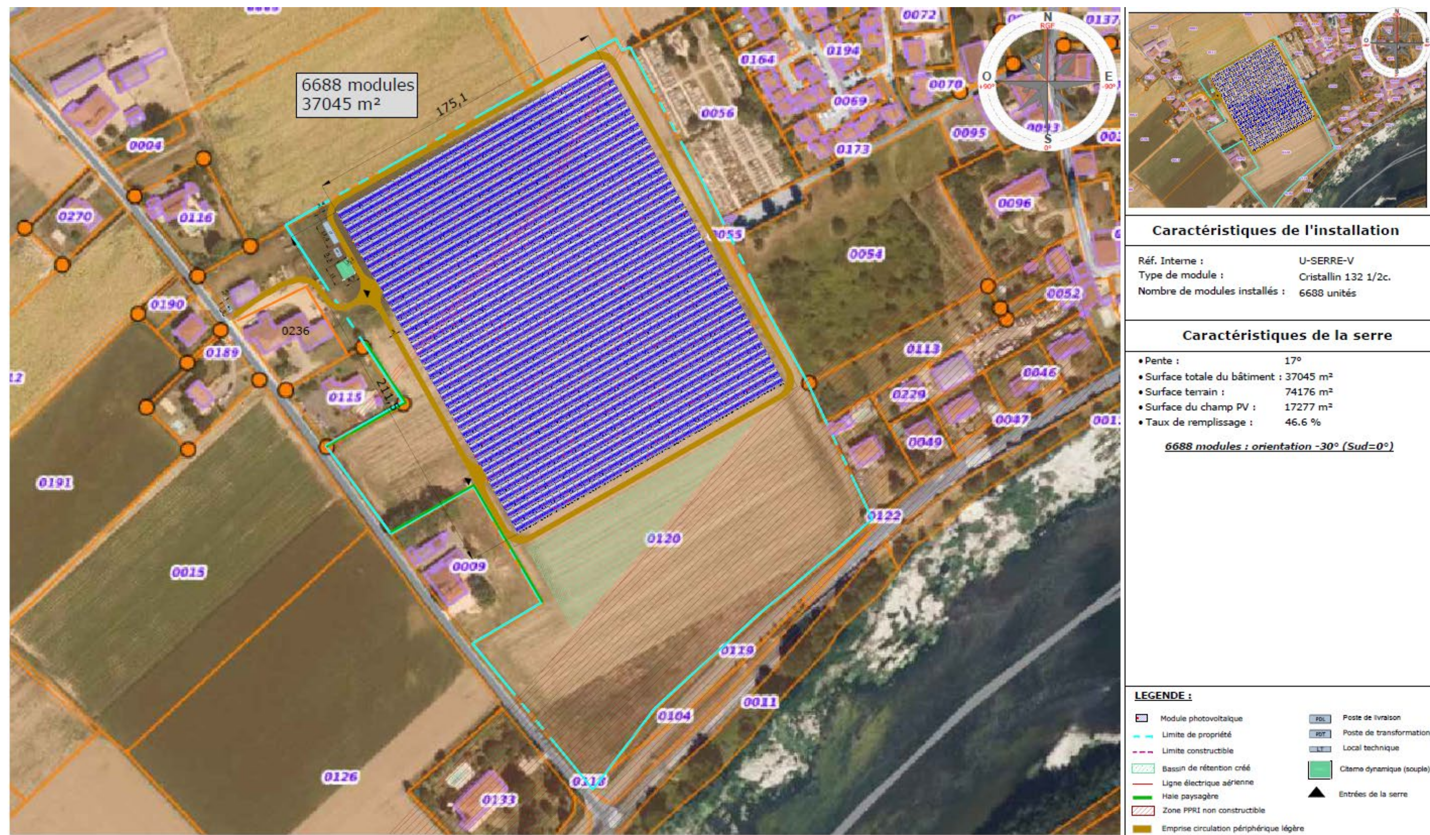
Plan de masse de la serre agricole photovoltaïque (dernière version)
