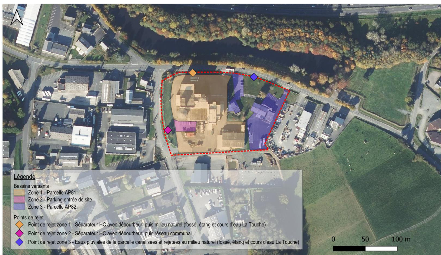
FIGURE 31 : MODE DE GESTION DES EAUX PLUVIALES
