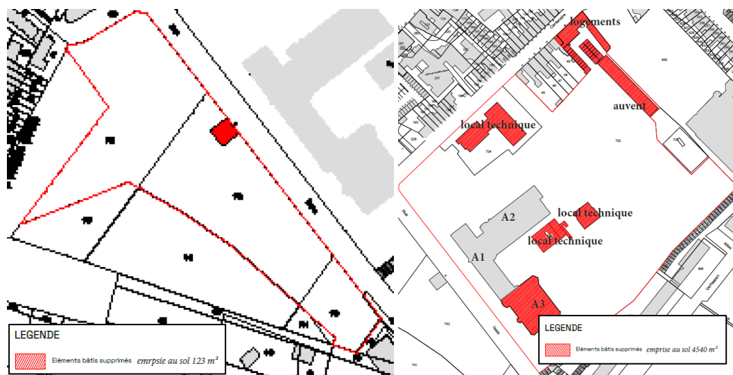
Figure 11 - Plan de démolition (PA Nord/PA Sud)
