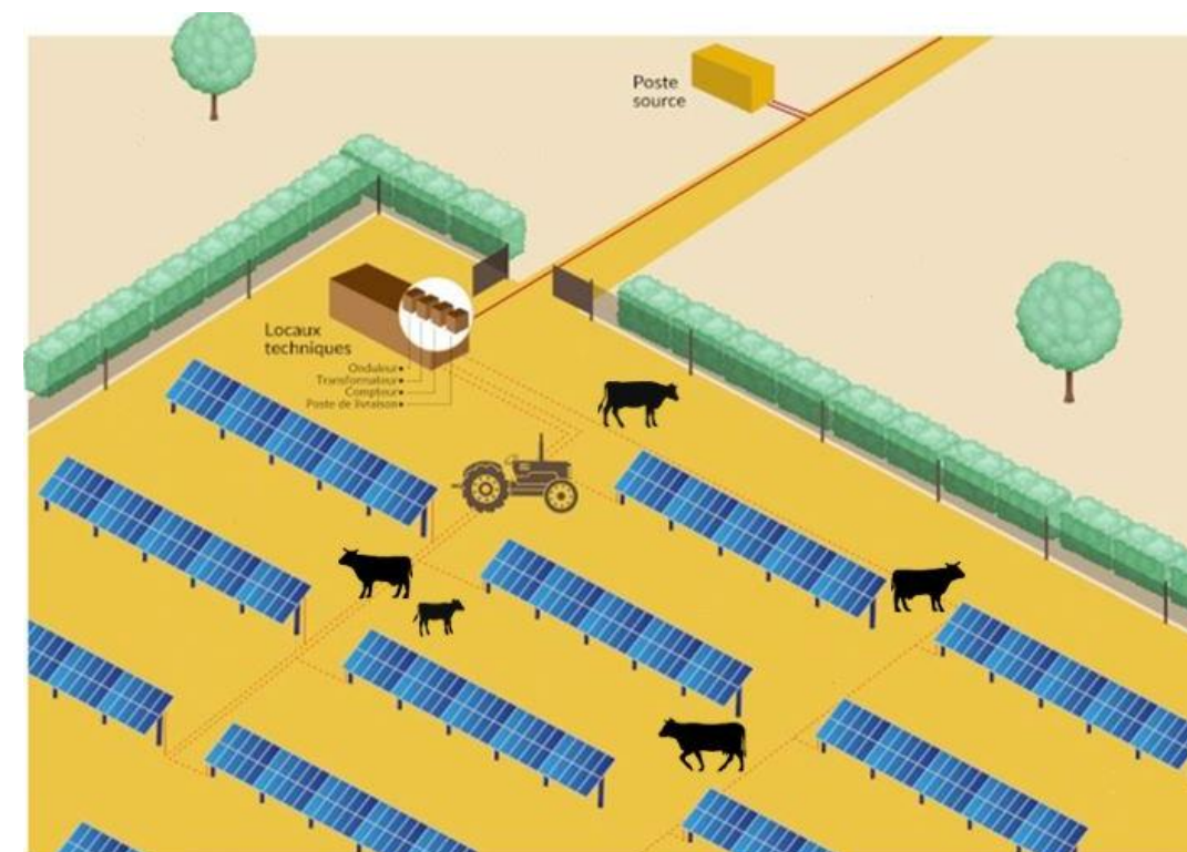
Figure 2 : Schéma de principe d'une installation-type agrivoltaïque
