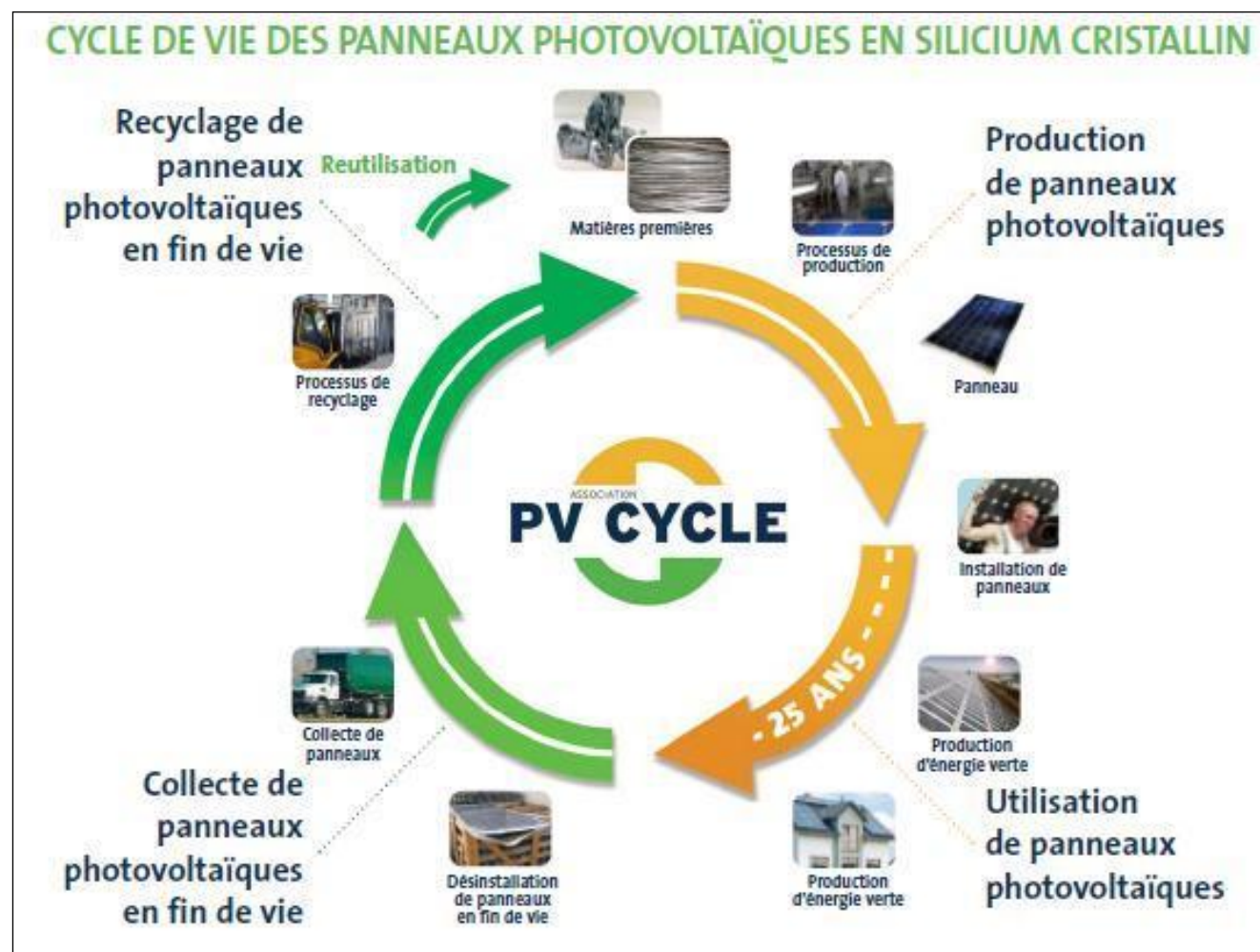
Figure 9 : Cycle de vie des panneaux photovoltaïques
