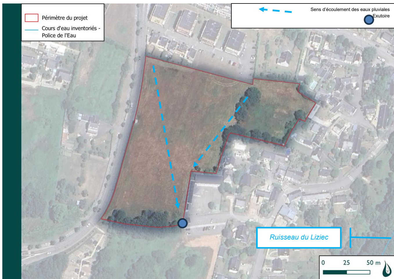
Figure 7 : Sens d'écoulement des eaux pluviales et localisation de l'exutoire à l'échelle du terrain d'assiette – DMEAU 2026
