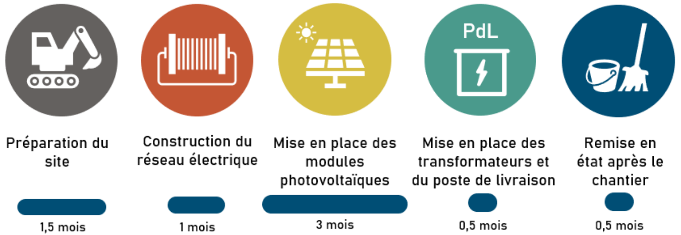
Figure 1 : Durées approximatives et phases de travaux de construction d'un parc photovoltaïque Remarque : Les délais sont donnés à titre indicatif. Certaines phases peuvent se dérouler en parallèle.
