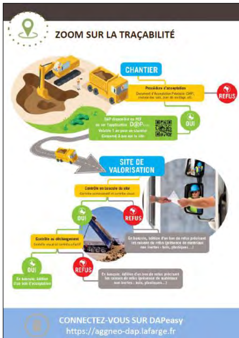
SSynoptique du protocole d'admission – Source : guide LAFARGE diffusé à ses clients (version Janvier 2023)
