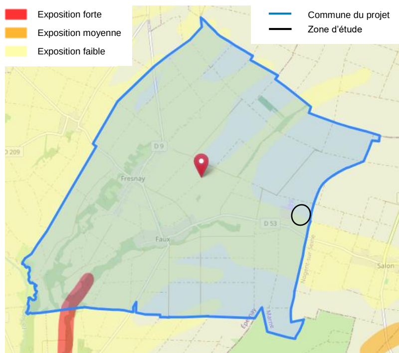
Figure 16 : Exposition au risque de retrait et de gonflement des argiles (Source : Géorisques).
