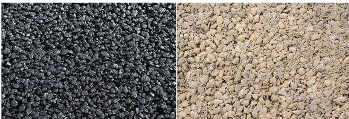
Figure 11. Comparaison de l'enrobé bitumineux classique (noir) et de l'enrobé au liant végétal (beige).
