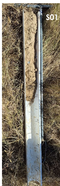
Figure n°7. Illustrations d'une extraction représentative du sol diagnostiqué sur l'emprise du projet agrivoltaïque : S01 : limono-sableux faiblement argileux – non humide
