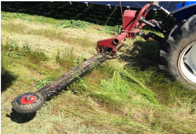
Figure 29 : Exemple de barre de coupe adaptée au parc photovoltaïque (source Serpe)
