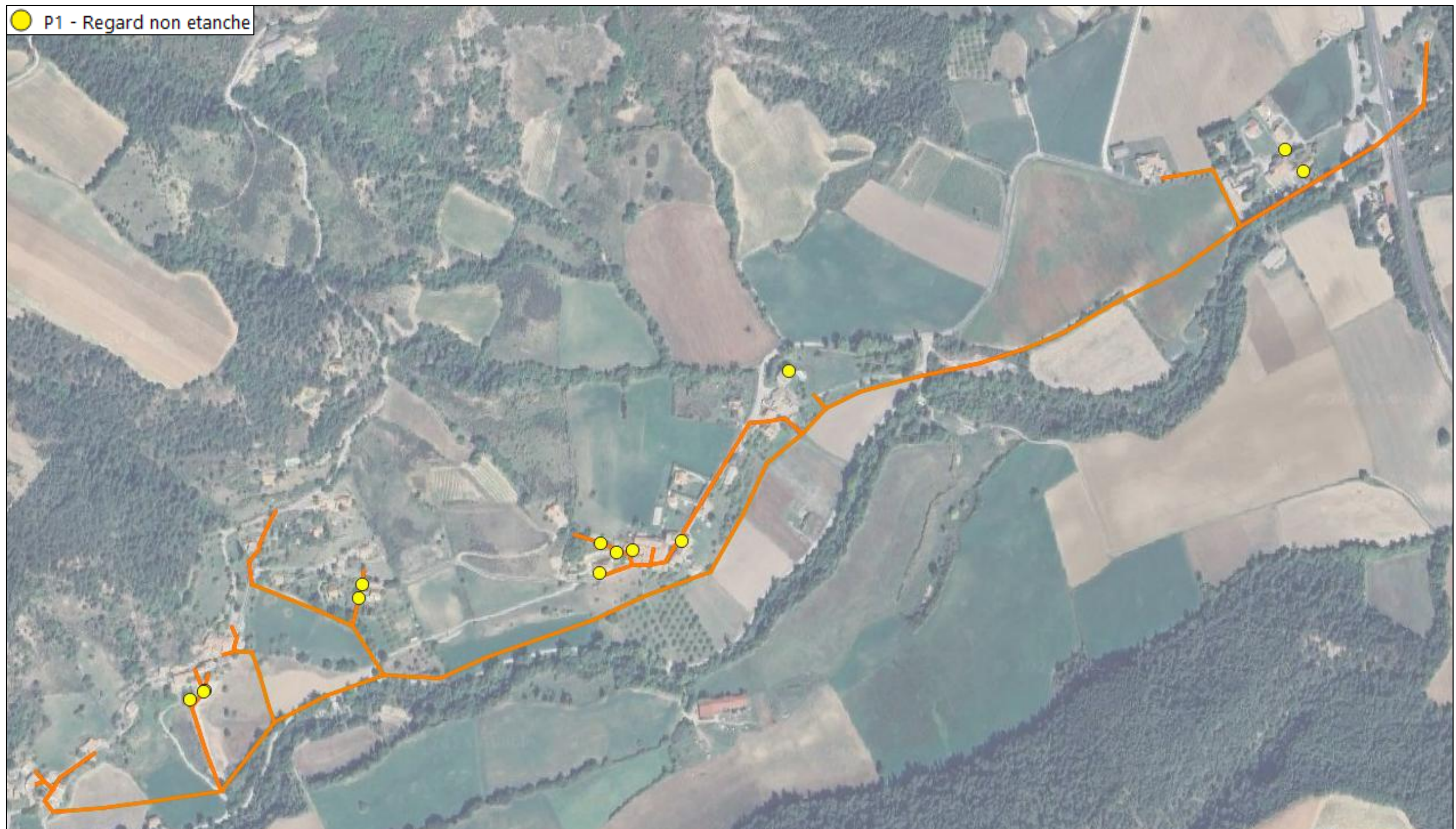
Figure 38 : Localisation des travaux pour l'élimination des ECPM provenant de l'étanchéité des regards
