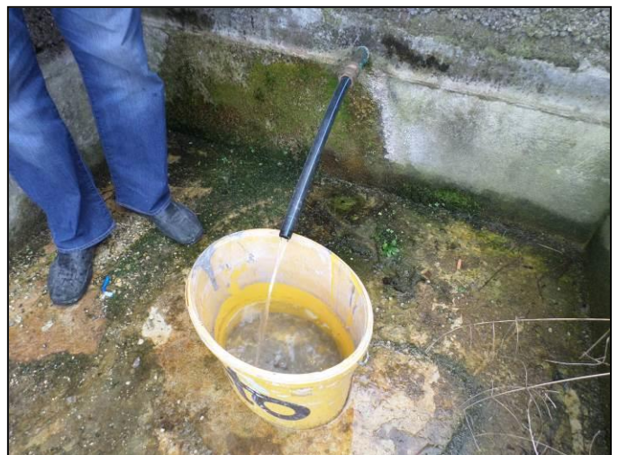
Figure 46 : Mesure du débit de la source par empotage
