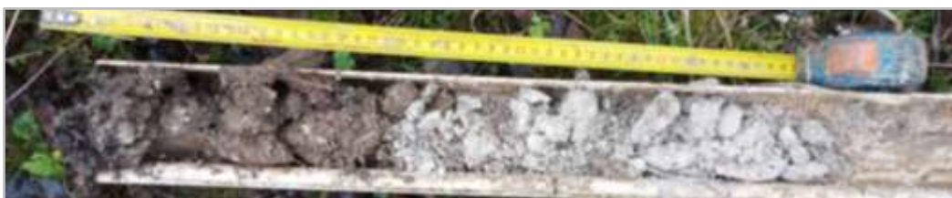
Photo 14 : Profils pédologiques d'ANTHROPOSOLS reconstitués, à forte charge en éléments grossiers calcaires et à texture limoneuse à sableuse (de haut en bas : Sondages P9 et P13) – Photos prises sur site, © Rainette, 2026.
