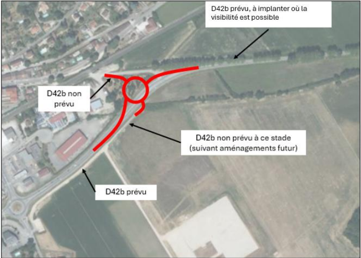
Figure 34 : Position des D42b sur le giratoire
