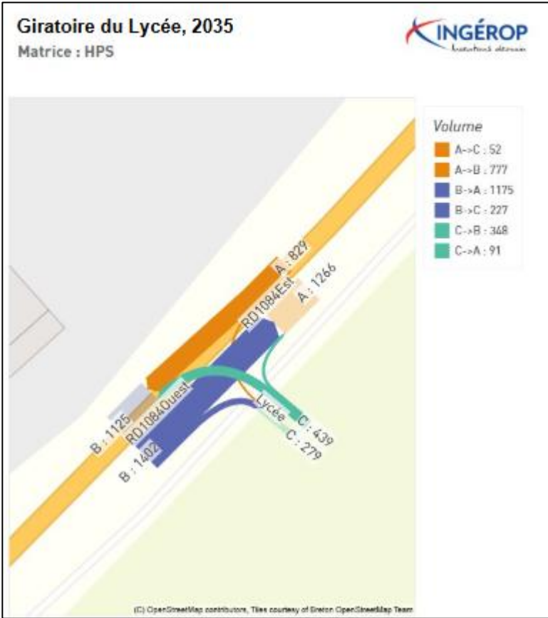
Figure 6 : Simulation du trafic sur le giratoire en 2035 (HPS)
