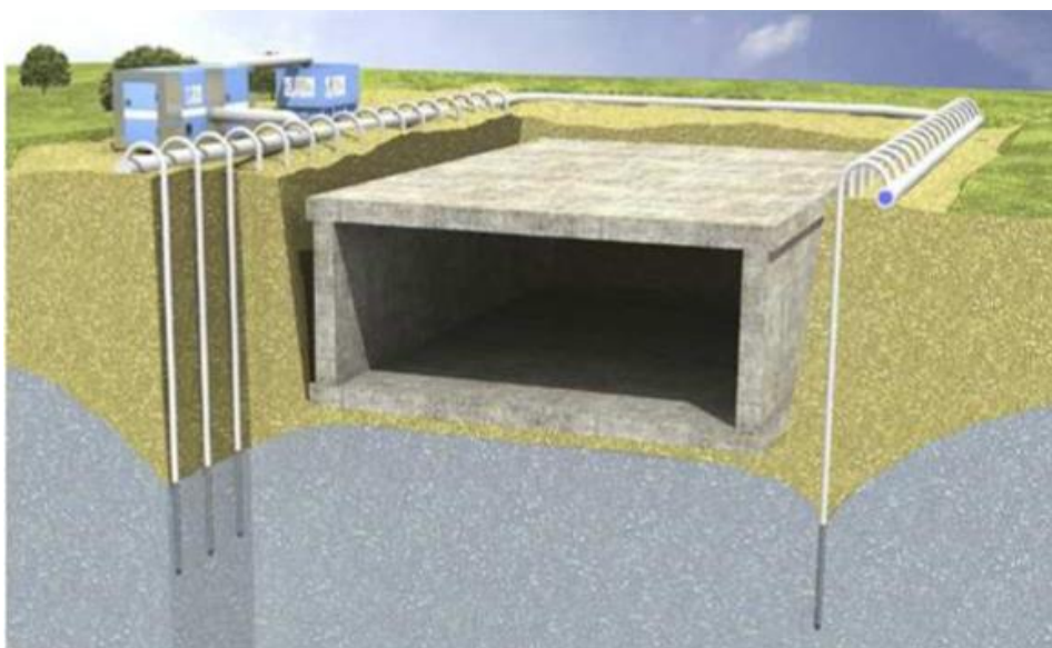
Figure 8 : illustration d'un système d'aiguilles filtrantes
