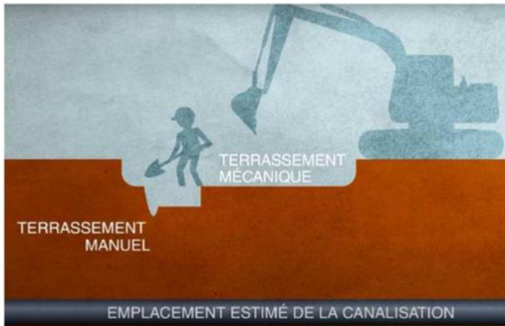
Figure 5 : représentation schématique de l'ouverture d'une fouille
