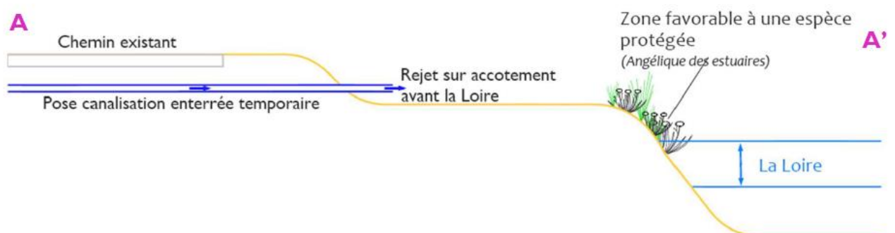
Figure 13 : Coupe de principe du rejet sur l'accotement avant la Loire
