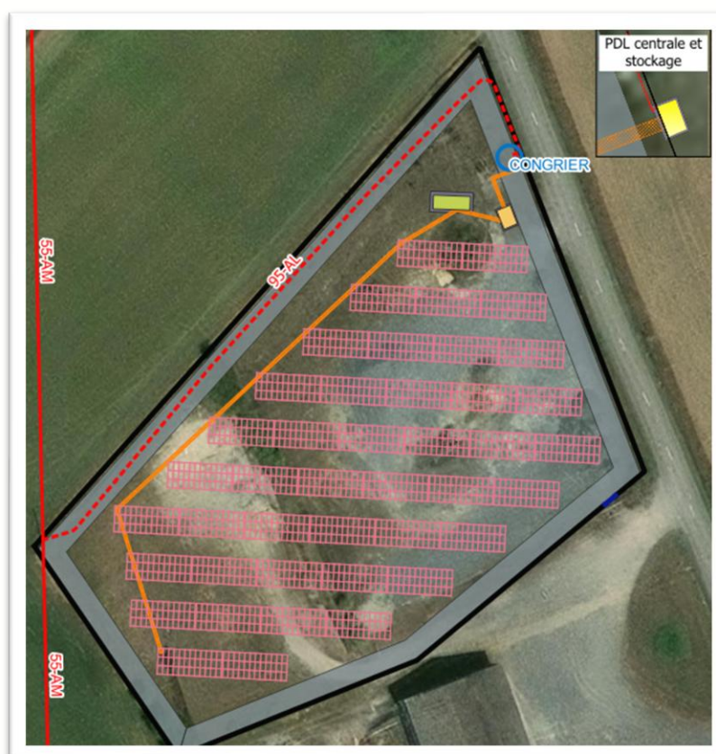
Figure n°8 : Plan d'implantation centrale photovoltaïque
