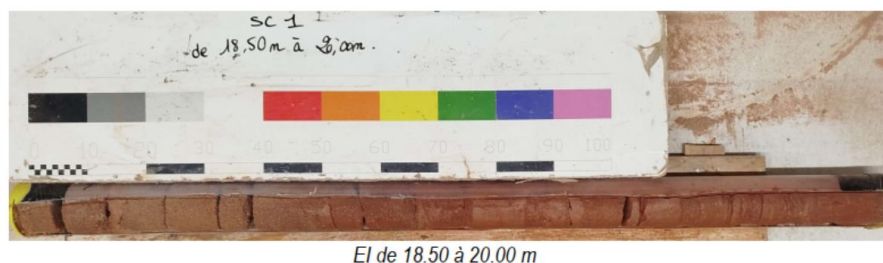
Fig. 18 : Illustration d'un échantillon de carottes jusqu'à 20.00m de profondeur. Source : Ginger
