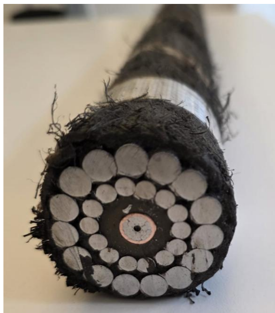
Figure 2-1 : Câble de télécommunication à fibres optiques SEA-ME-WE 3 segment 10 tel que relevé au large de la Bretagne
