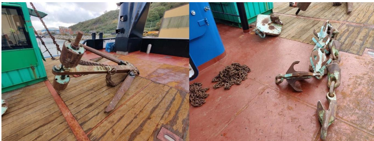
Grappin désensouilleur (à gauche) et assemblage de grappin type Flatfish (à droite)
